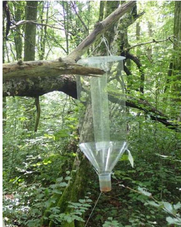
FIGURE 4 – Piège d'interception Polytrap en place (C. Duflo).
