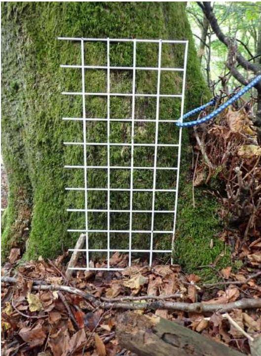
FIGURE 3 – Dispositif d'inventaire des bryophytes et lichens par grille (C. Duflo).
