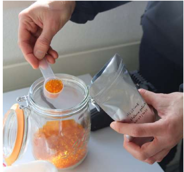
FIGURE 10 – Insertion de silicagel dans un sachet thermosoudable (J. Amiotte-Suchet)
