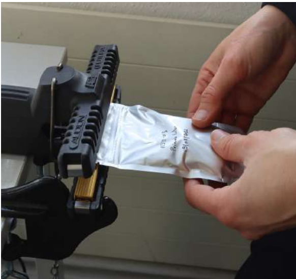
FIGURE 9 – Soudure d'un sachet thermosoudable (J. Amiotte-Suchet)
