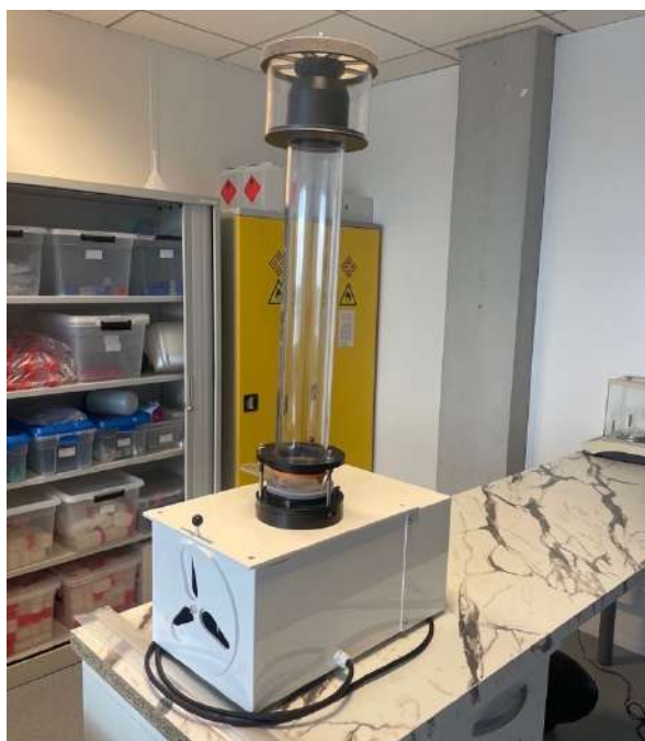
FIGURE 6 – Colonne à air pour le tri de certaines graines (T. Dreux)
